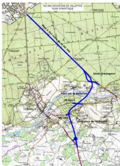
La déviation se décompose en 2 tronçons. Le premier (mise à 2x2 voies de la RD 765) a été ouvert à la circulation en 2012 et le deuxième tronçon correspond à une route nouvelle de 3,4 km pour rejoindre la RD 956 au sud de Cellettes.
